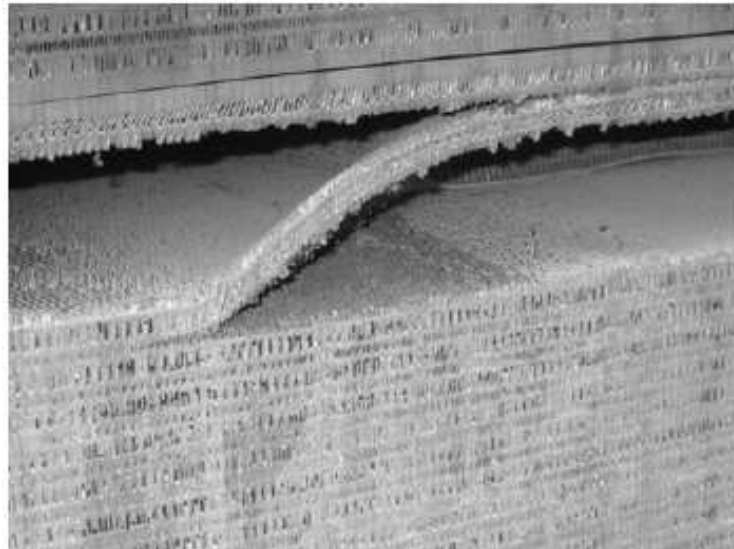
Figure I-4 - Séparation de base due à la corrosion d'amalgames
